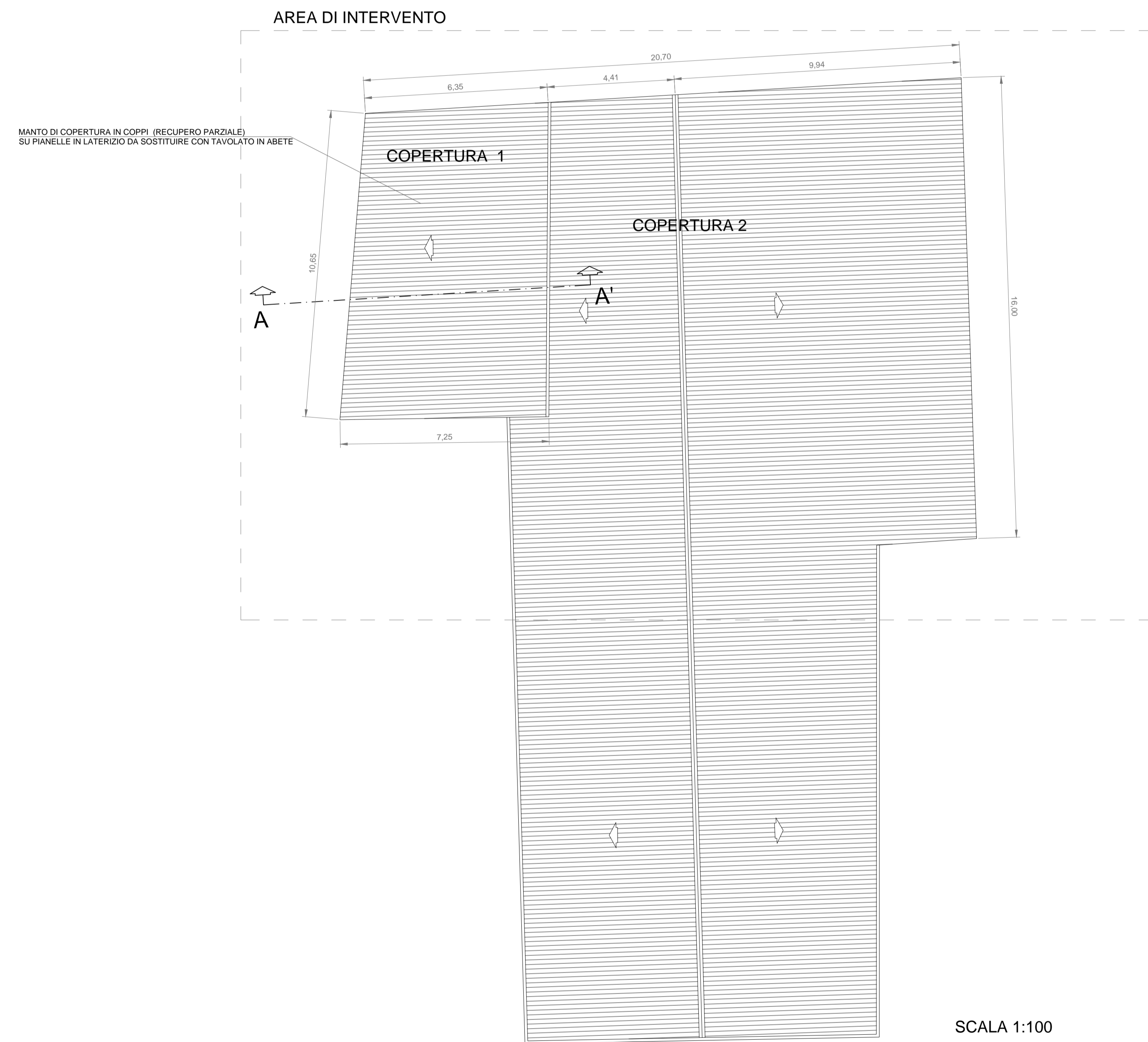
PIANTA DELLE COPERTURE ANTE OPERAM
